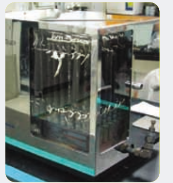
● 1kW급 SOFC 스택
